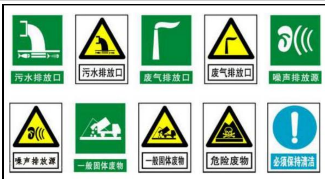
图 7-1 排污口图形标志示例
