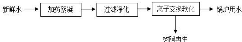
图 2-1 锅炉软水制备工艺流程图
